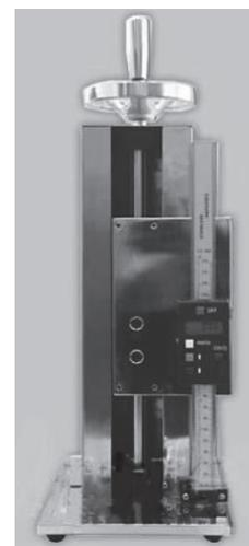
Рисунок 7 – Разрывная машина типа МТ-140RV
