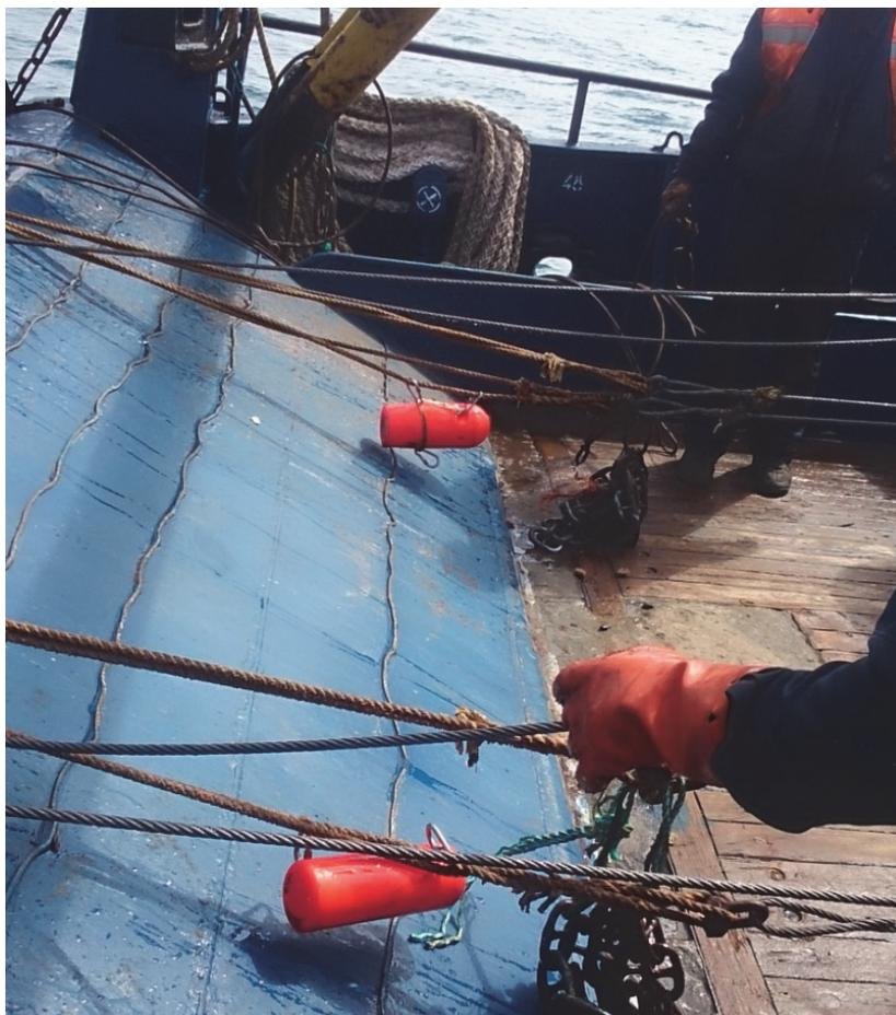
Рисунок 3 – Оснащение крыльев трала датчиками горизонтального раскрытия
