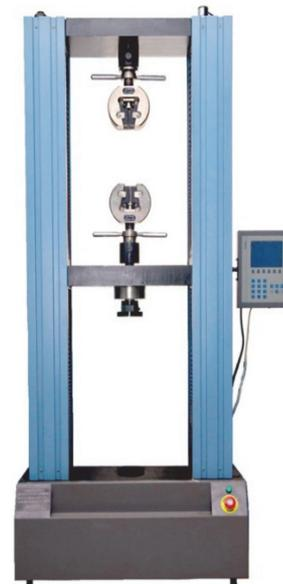
Рисунок 2 – Электромеханическая разрывная машина
