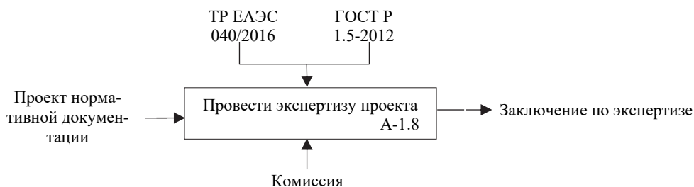
Рисунок 8 – Функциональный блок (А-1.8) «Экспертиза проекта»
