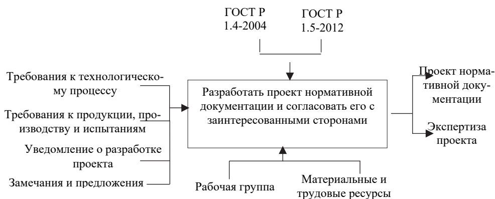
Рисунок 7 – Функциональный блок (А-1.7) «Разработка проекта нормативной документации и согласование его с заинтересованными сторонами»
